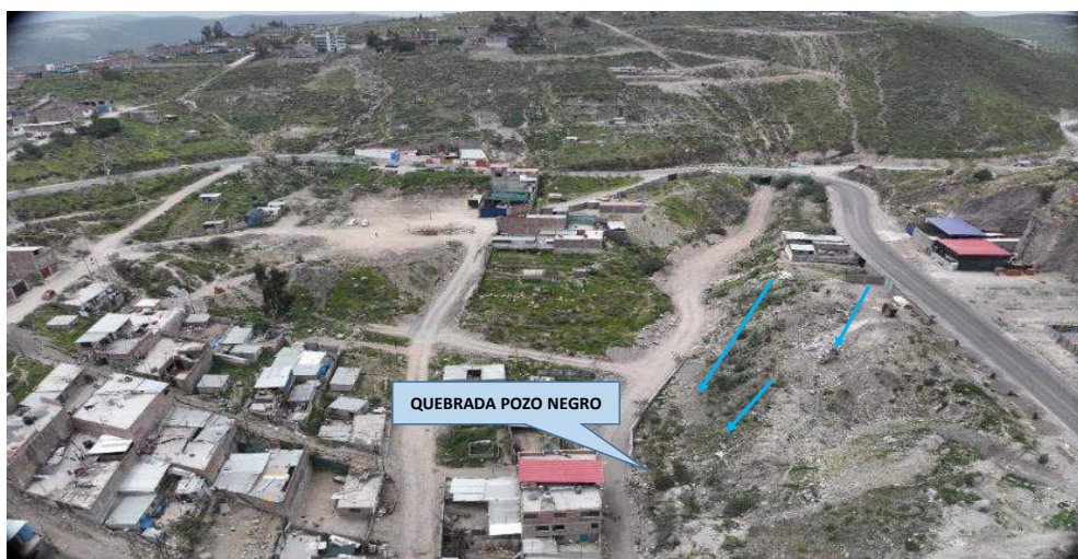
IMAGEN 03: EN ESTE TRAMO SE OBSERVA EN LA QUEBRADA POZO NEGRO, SU CAUCE SE ENCUENTRA COLMATADO DE SEDIMENTOS, Y SIN PROTECCION EN AMBAS MÁRGENES; VISTA DE PLANTA MEDIANTE DRON.
